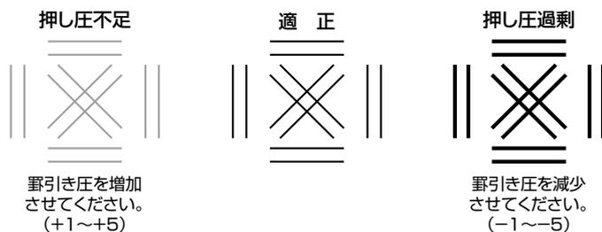
罫引きしたテストパターンの状態を確認します。罫引きが浅い場合には罫引き圧が不足しています。逆に罫引きが深い場合や切れている場合は罫引き圧が過剰になっています。
