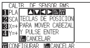
8 Presione la tecla POSITION (▲▼◀▶) y mueva el carro de la herramienta a la posición para trazar la marca de registro (la posición en la que no se imprime nada).
