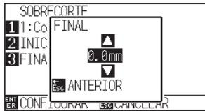
**11** Presione la tecla POSITION (▲▼) e incremente o disminuya el valor del parámetro.
