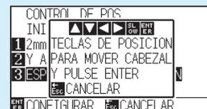
Pulse la tecla POSITION (▲▼◀▶) para mover la posición de la herramienta y, a continuación, pulse la tecla [ENTER] para realizar el ajuste.
