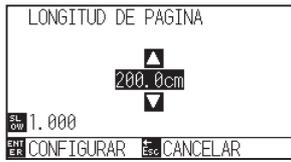
**4** Presione las teclas de POSITION (▲▼) para cambiar la configuración actual.
