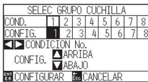
9 Presione la tecla POSITION (◀▶) para seleccionar el núm. de condición de la herramienta (CONDICIÓN No.).
