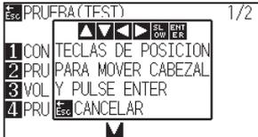
**7** Presione la tecla POSITION (▲▼◀▶) para mover el carro de la herramienta a la posición de inicio de la impresión.
