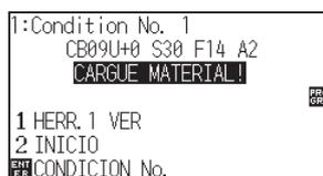
Palanca del material levantada (Rodillo de presión levantado)
