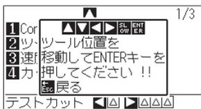
テストカットの結果を確認し、最適な設定になるように速度／カット圧／加速度を調整します。一般的なカッティング用シートの場合、台紙に薄く切り跡がつく程度にします。また、三角形や四角形の角を確認し、角がきれいに切れるようにオフセットを調整します。
