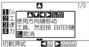
确认测试切割的结果，调整速度／力度／加速度，使其处于最佳设定。如果是普通的载片用纸，底纸上会留下淡淡的切痕。此外，请确认三角形、四角形的角，调整偏移量，实现良好的角切割。
