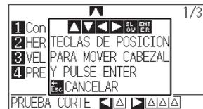
Compruebe el resultado del corte de prueba y ajuste la VELOCIDAD, PRESI. y ACELERACION en el valor óptimo. Al usar una hoja de corte general, ajuste a un valor que cause un ligero rasguño en la hoja de soporte.
