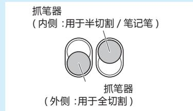
工具 1: 使用安装于抓笔器内侧的工具的情况
