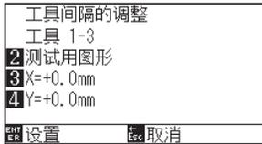
7 以使用笔柱塞 (工具 1) 描画的 “+” 为基准, 测量使用切刀柱塞 (工具 3) 切割的 “+” 有多少偏差。(例如图的请, 由于在 -X 方向 / +Y 方向有偏移, 输入 X = + \* mm、Y = - \* mm)。
