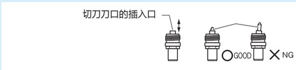
如果不正确安装，将导致破损。
