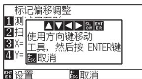
8 按下 POSITION (▲▼◀▶) 键 将工具移动到标记绘图位置 (没有任何刻印的位置)；
