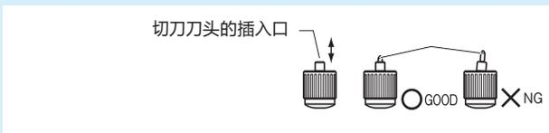
如果不正确安装，将导致破损。
