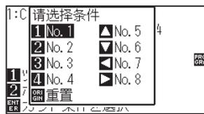
2 按下 [ENTER] 键, 同时按下 [1] ~ [4]、POSITION (▲▼◀▶) 键, 选择切割条件 (工具条件)。(项目为反转显示状态)
