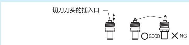
如果不正确安装，将导致破损。
