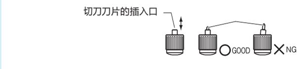
如果不正确安装，将导致破损。
