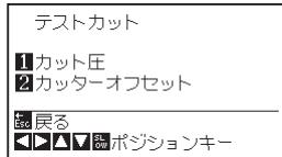
(2) POSITION (▲▼◀▶) キーを押して、テストカットを行う位置にツールキャリッジを移動させます。
