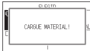
Palanca de configuración del material levantada
