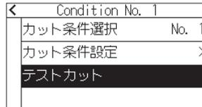
テストカットの結果を確認し、最適な設定になるように速度/カット圧/加速度/隙間長さを調整します。メディアの厚さより少し多い刃出し量が最適です。また、角がしっかりカットできていなかったり、切れすぎている場合は、オフセット値と隙間長さを調整します。
