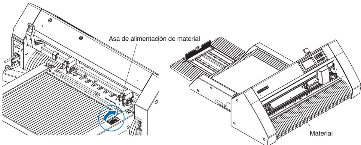
2. Ajuste la posición del rodillo de empuje de manera que la distancia entre el borde del material y el borde del rodillo de empuje sea de 5 mm.
