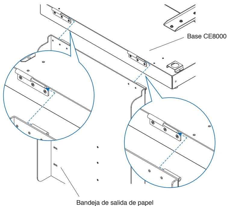
3. Utilice un destornillador Phillips para fijar el soporte de fijación de la bandeja (A) y el soporte de fijación de la bandeja (B) con los cuatro tornillos B.
