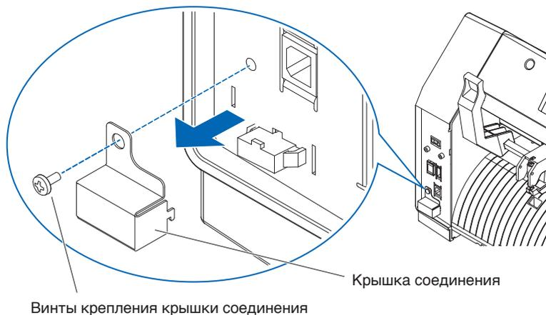
2. Установите ASF1-30. Поднимите ASF1-30 Крепежные крючки, вставьте ASF1-30 Позиционирование выступов в CE8000-40, а затем вставьте ASF1-30 Крепежные крючки сверху.
