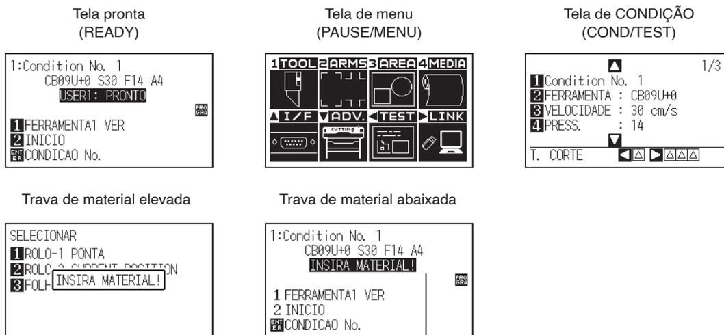
Configura a condição do material (Estado PRONTO: Exibirá "PRONTO" quando o material tiver sido carregado)
