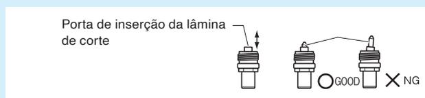
Se não for instalada corretamente, pode resultar em danos à lâmina de corte ou à própria plotadora.
