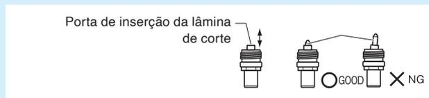
Se não for instalada corretamente, pode resultar em danos à lâmina de corte ou à própria plotadora.
