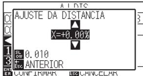
**7** Pressione as teclas de POSITION (▲▼) e aumente ou diminua o valor de configuração.
