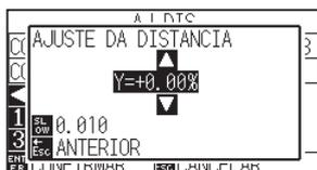
**10** Pressione as teclas de POSITION (▲▼) e aumente ou diminua o valor de AJUSTE DE DISTÂNCIA Y.
