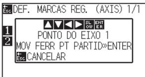
6 Pressione a tecla de POSITION (▲▼◀▶) para mover a ponta da ferramenta para a posição da marca de alinhamento.
