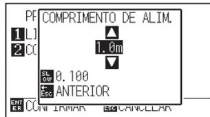
Aumente ou diminua o valor de configuração utilizando a tecla de POSITION (▲▼). Selecione a troca de unidade com a tecla [SLOW].
