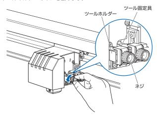
2 ツールホルダーを上に押し上げながら、ツールのツバ部分がツールホルダーの上面に突き当るまでツールを完全に押し込みます。
