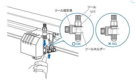
3 ツールのツバ部分を覆うようにツール固定具をセットし、ネジを締めてください。
